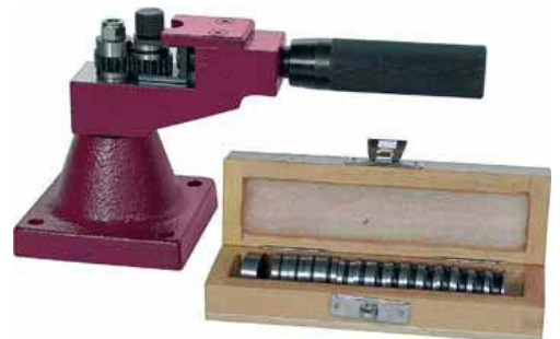
Alargadora de anéis com mesa e pedras Completa de 17 roletas de diferentes formas
